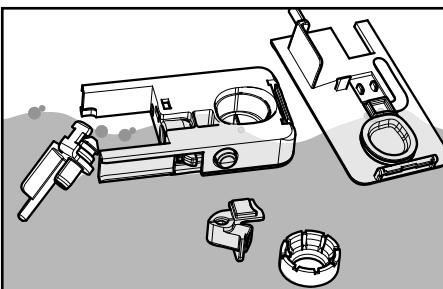
15 Примечание: после промывки снова установите компоненты, выполняя в обратном порядке действия для демонтажа.
