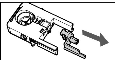
13 Снимите соединение всасывающей трубы с Cappuccinatore.
