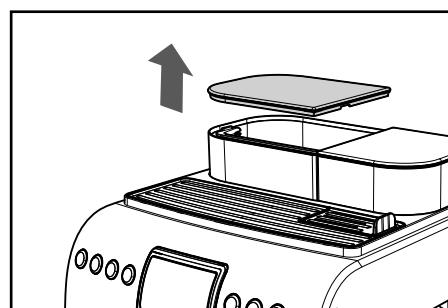
**2** Достаньте бак; поднимите его при помощи специальной ручки, установленной внутри бака.
