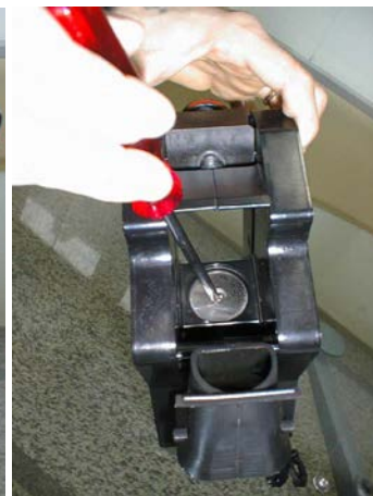
Снять внутренний фильтр, вымыть горячей водой, удаляя с него кофе.
