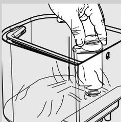
**4** Вставьте фильтр в пустой бак для воды. Сдвиньте его как можно ниже.
