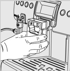
**1** Извлеките устройство подачи и вымойте его водой.
