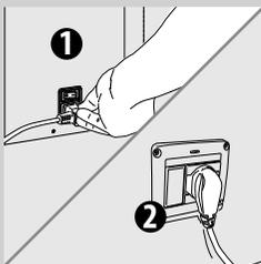
**14** Вставьте штепсельную вилку в розетку, расположенную в задней части машины.
