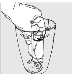
**3** Опустите фильтр в вертикальном положении (отверстием вверх) в холодную воду и убедитесь в том, что отверстие фильтра находится вверху. Слегка нажмите на боковые стенки, чтобы вышли пузырьки воздуха.
