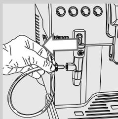
**1** Удалите штырь со всасывающей трубкой из насадки Cappuccinatore.
