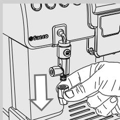
**2** Снимите концевую часть с насадки Cappuccinatore.
