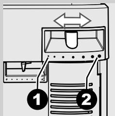
Регулировку можно выполнять с помощью рычага, расположенного сбоку машины.
