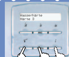
Entsprechenden Härtegrad anwählen (z.B. 2 Quadrate = Härte 2) und mit der Menü-Taste speichern.
