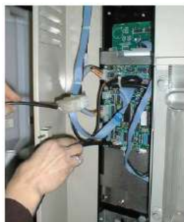
Подключить кабель к процессору
