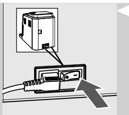
**12** Установите главный выключатель, расположенный сзади машины, в положение «I».
