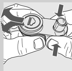
**20** Чтобы снять автоматический вспениватель молока, надавите на него с двух сторон и достаньте, слегка сдвигая его вбок, как показано на рисунке.
