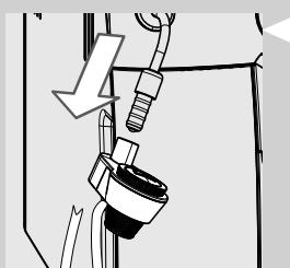
**18** Снимите резиновую ручку с трубы пара.
