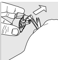
**19** Снимите всасывающую трубку.
