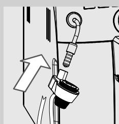
**27** Наденьте автоматический вспениватель молока на защитную резиновую накладку, чтобы он защелкнулся в правильном положении.
