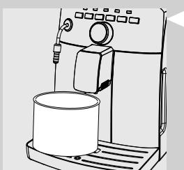
**6** Подставьте вместительную емкость (1,5 л) под трубку пара / горячей воды и устройство подачи.
