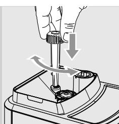
**1** Нажмите и поверните ключ регулирования помола только на одно деление за раз. Разница вкуса будет ощутимой после подачи 2-3 кофе.
