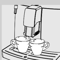
Под устройством подачи могут быть размещены две чашки/чашечки
