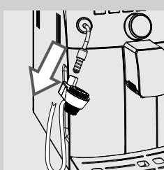
**2** Снимите автоматический вспениватель молока с трубки пара/горячей воды.
