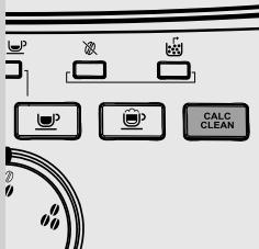
В процессе использования внутри машины образуется накипь, которую необходимо регулярно удалять, если этого не делать, может произойти засорение водяного контура и контура кофе. Машина сама уведомит, когда нужно будет выполнить удаление накипи. Если свето-диод «**CALC CLEAN**» горит, не мигая, необходимо удалить накипь.
