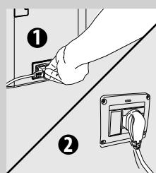
**10** Вставьте штепсельную вилку в розетку, расположенную в задней части машины.
