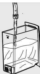
**8** По окончании еще раз наполните бак для воды до уровня MAX. Теперь машина готова к работе.
