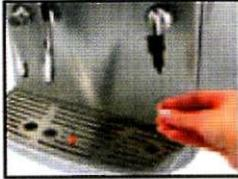
Прочистите трубку с помощью тонкой иглы.<br><b>!</b> Перед очисткой, выключите кофемашину и закройте ручку пара/кипятка |
