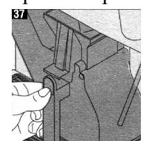
При установке рабочего блока на место не нажимайте рычаг "PRESS". Просто устанавливайте его в посадочное место с легким усилием.
