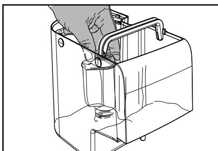
**13** Наполните бак свежей питьевой водой и вставьте его обратно в машину.
