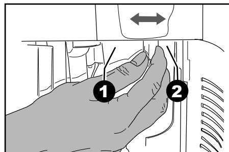
Метки указывают установленную степень помола; можно установить различные степени помола с помощью следующих меток:
