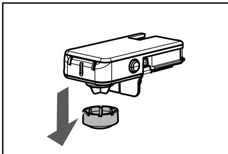
**11** Поверните и поднимите крышку Cappuccinatore, чтобы отсоединить ее от корпуса Cappuccinatore.
