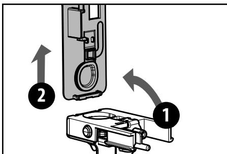
**13** Снимите соединение всасывающей трубы с Cappuccinatore.
