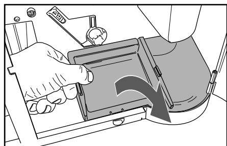
**5** Закрепите основание с контейнерами при помощи винтов в комплекте.
