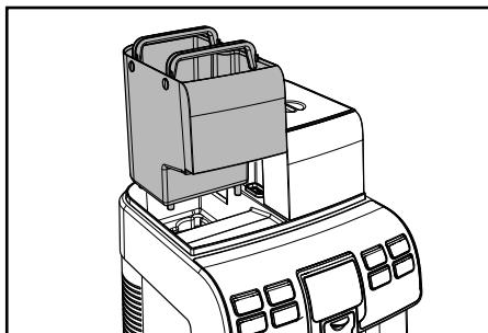
**4** Ополосните его и наполните свежей водой; не превышайте максимальный уровень (MAX), указанный на баке.
