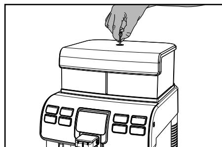
**2** После разблокирования поднимите и снимите крышку.
