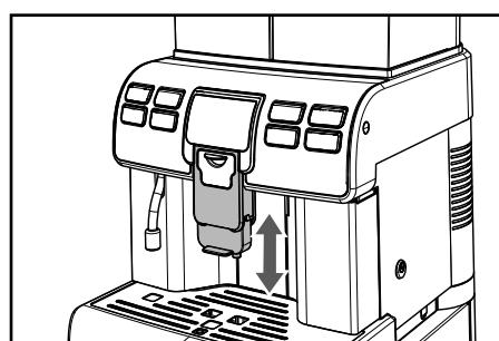
Для выполнения регулировки приподнимите или опустите вручную устройство подачи.
