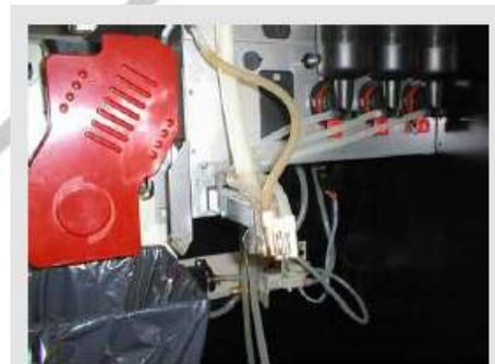
Сервомотор приводит в движение и останавливает дозирующее плечо, после чего сахар высыпается в стаканчик.
