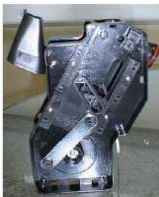
Повернуть заварочную камеру в сторону выброса использованного кофе и повернуть желоб для кофе.
