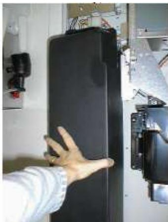
Снять крышку механизма монет
