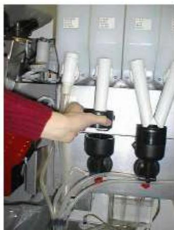
Осторожно снять и вымыть: засасывающий элемент смешивающей миски;
