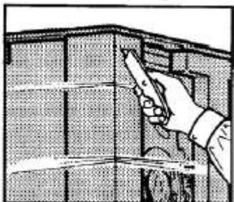
Разрезать предохраняющую пленку вдоль защищенных углов автомат
