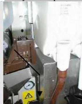
Моторедуктор вращает винтовой механизм в контейнере с сахаром, который насыпает соответствующее количество сахара в дозировщик.
