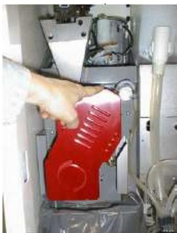
снять красную крышку заварочной камеры;
