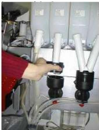
Снять всасывающую насадку смешивающей миски.
