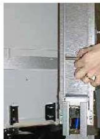
Снять металлический груз.
