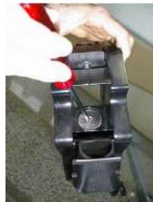
Снять нижний фильтр, вымыть горячей водой, удаляя с него кофе.
