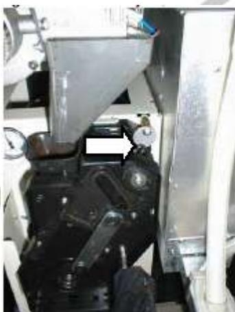
снять с крючка заварочную камеру, поворачивая рычаг;
