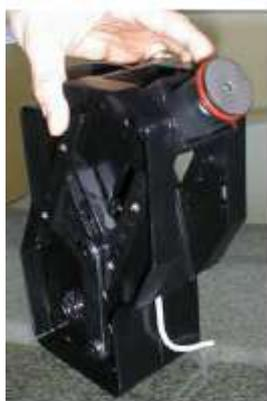
Повернуть верхний фильтр вверх, снять камеру в сторону выброса его и промыть горячей водой, удаляя с него кофе.
