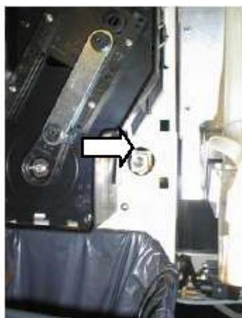
вынуть трубку, подводящую воду к заварочной камере;
