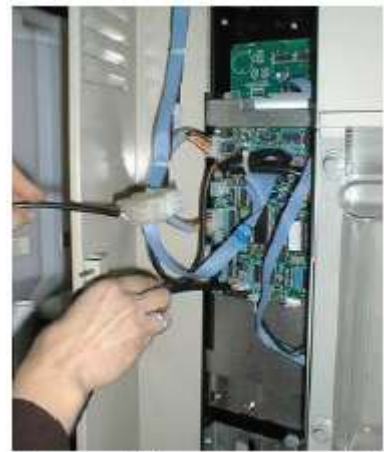
Подключить кабель к процессору
